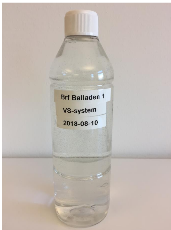
Figur 5. Flaskprov på VS-krets med synliga mikrobubblor.
