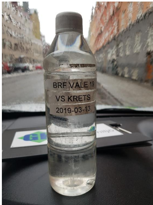
Figur 11. Systemvätskeprov som inte innehåller några mikrobubblor.
